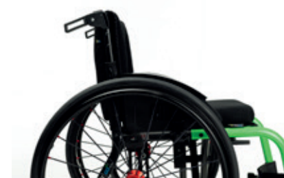
B82-C protège-vêtements longs amovibles et réglables avec garde-boue, en carbone.
